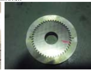
ワイヤーカットによるギアの加工品
